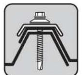
Vis de couture : vis auto-perceuse 6.50 mm x 19mm (3/4 de pouce) avec rondelles de 19 mm & joint EPDM
