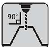
Commencez la fixation des vis sur la panne de bord inférieur sur chaque crête de nervure.(1).
