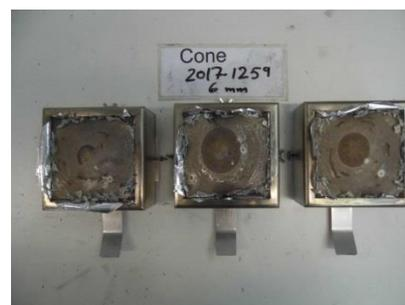
Aussehen der Proben nach dem Rauchdichteversuch
