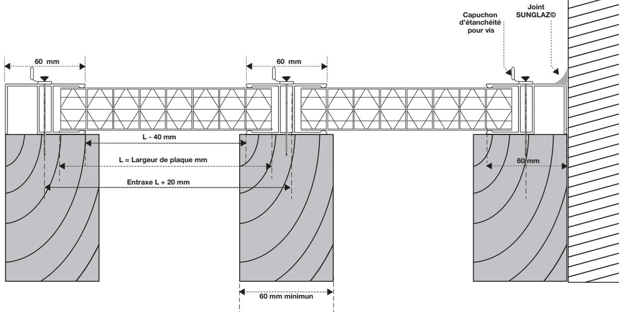
**6/** Préparez vos plaques, retirez le scotch provisoire des bords de plaques, relevez le film protecteur et obturez le haut de la plaque par le ruban adhésif plein et le bas par le ruban adhésif micro-perforé. Découpez et posez ensuite le profilé obturateur aluminium sur celui-ci, casse-goutte en bas. **(dessin 4 et 4a ou 4 et 4b)**
