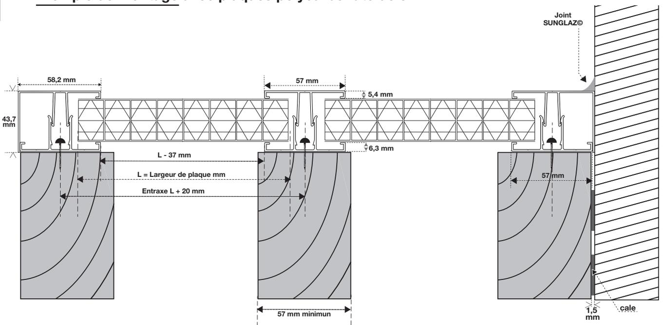
**2c****Exemple de montage avec plaques polycarbonate alvéolaire de 16 mm.**
