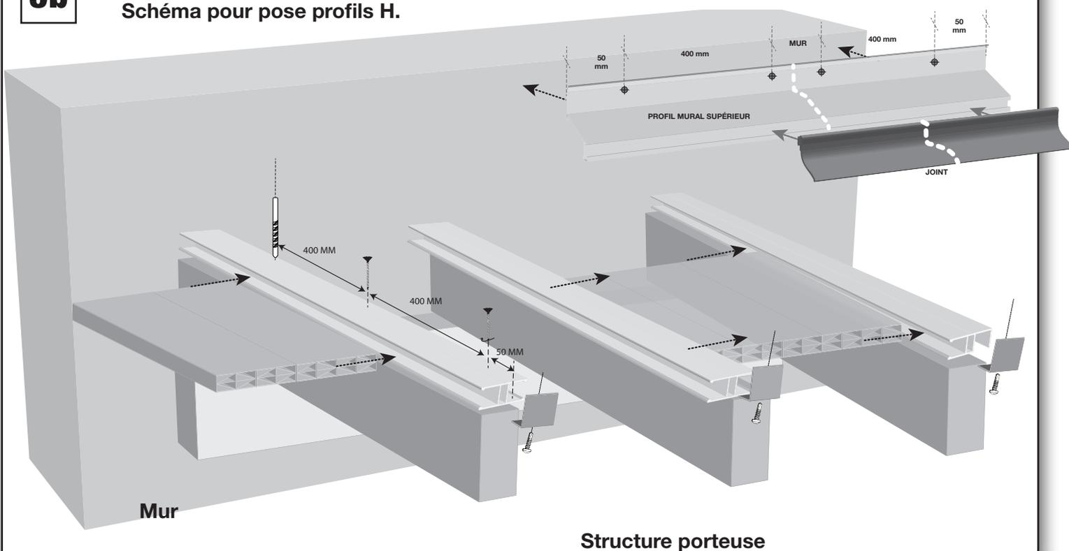
**ATTENTION :** Ne jamais marcher sur les plaques. Pour accéder à la fixation des capots, placez une planche de bois rigide en travers de 2 porteurs au minimum.
