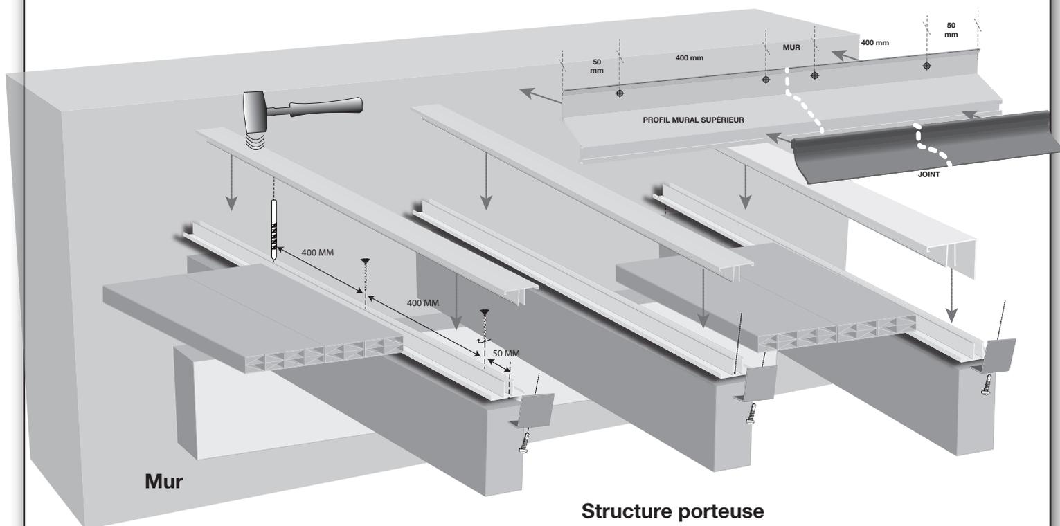
**ATTENTION :** Ne jamais marcher sur les plaques. Pour accéder à la fixation des capots, placez une planche de bois rigide en travers de 2 porteurs au minimum.
