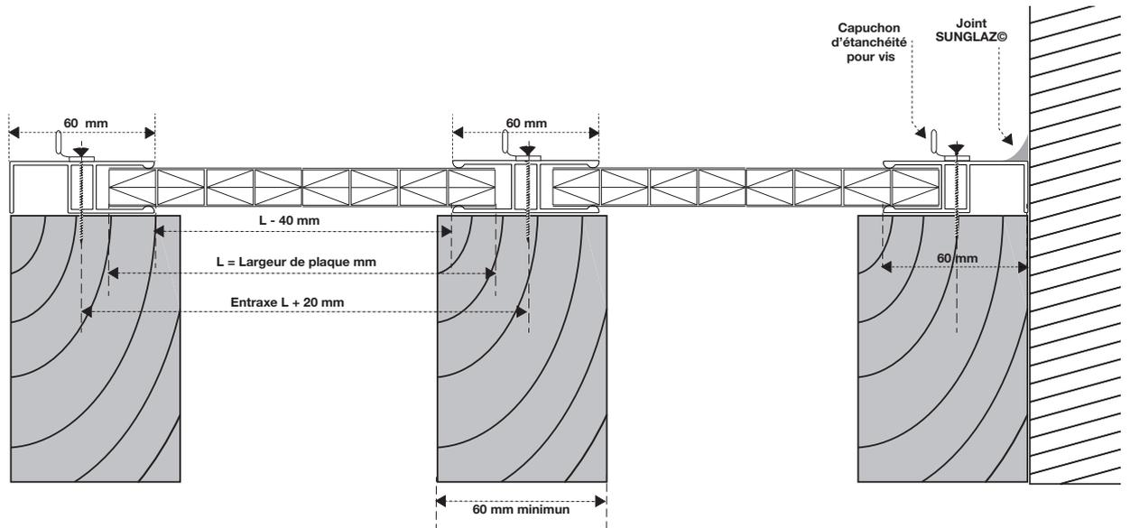
**2d****Exemple de montage avec plaques polycarbonate alvéolaire de 32 mm.**
