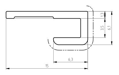
Sichtfläche: 12,7 mm (visible surface) Eloxalfläche: 51,2 mm (anodize surface) technische Abwicklung:
