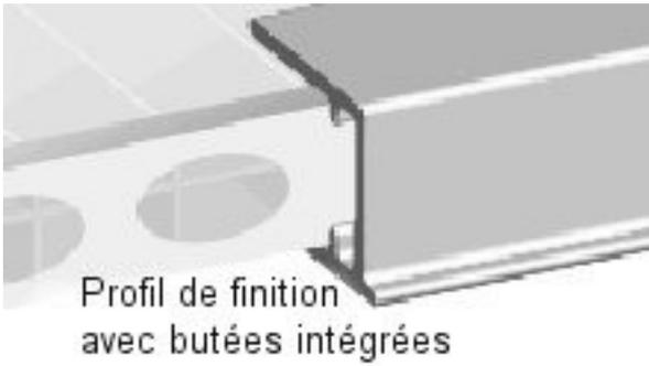
b) Hauteur minimale du fonds de feuillure du profilé de finition : 5mm au minimum.
