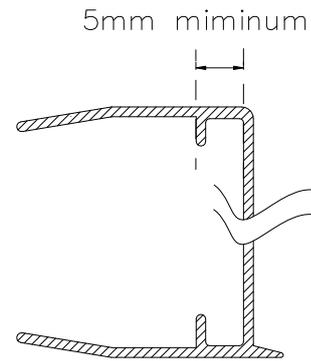
**Figure 3 – Coupe type des vitrages organiques multiparois « AkyVer® Sun Type » (cotations en mm).**
