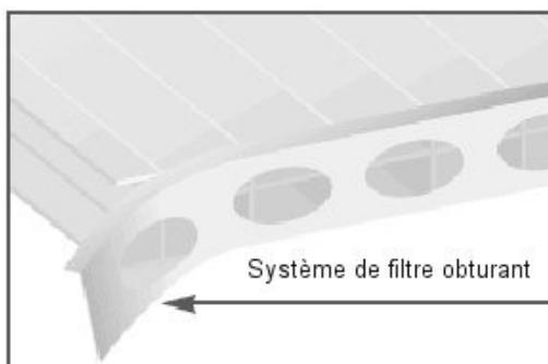
**Figure 2 – Profilé de finition type dans le cas d'une prise en feuillure du vitrage organique multiparoi « AkyVer® Sun Type » sur 3 côtés (1 petit côté libre)**
