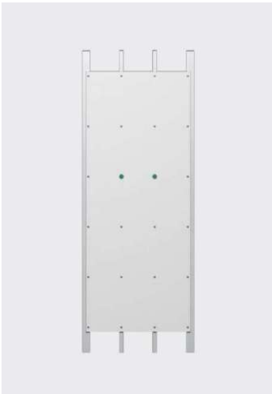
Figure 5 - Exemple de points de fixes (en vert) et de points coulissants (en gris)
